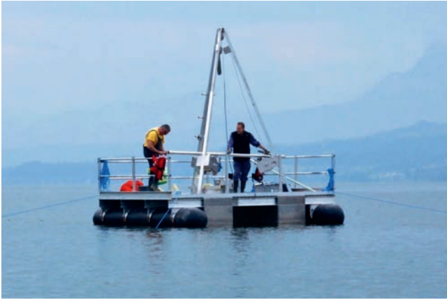
Abb. 2: Arbeitsplattform zur Abteufung von Sedimentbohrungen.
